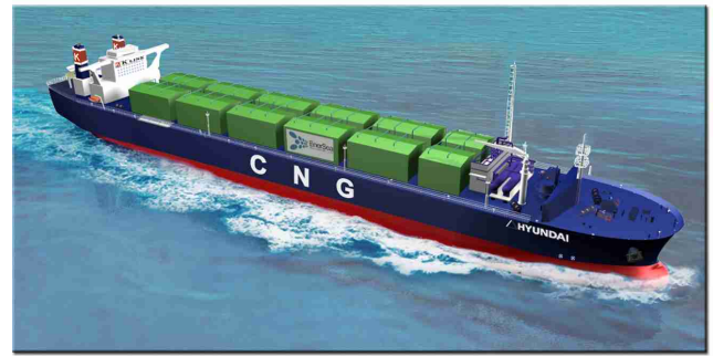
Votrans CNG Vessel - 700 MMscfd; 18kt.
